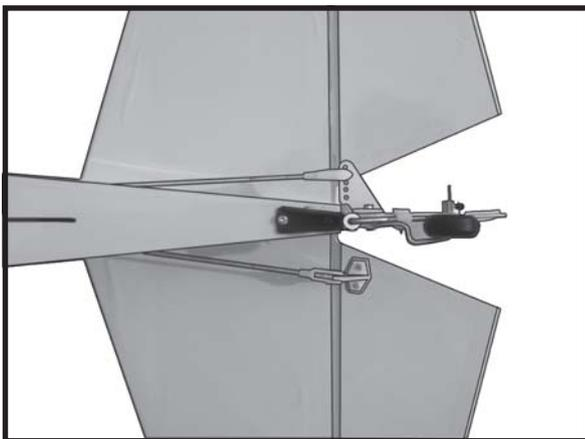
**INSTALLING THE FUSELAGE SERVOS.**
