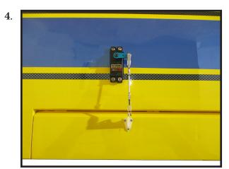
INSTALLING THE AILERON PUSHROD
